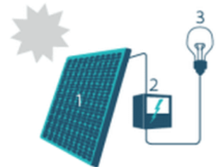
1. Zonnepaneel | 2. Omvormer | 3. Elektrische toestellen
