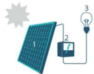
1. Zonnepaneel | 2. Omvormer | 3. Elektrische toestellen
