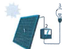
1. Zonnepaneel | 2. Omvormer 3. Elektrische toestellen
