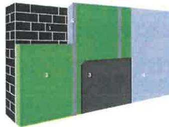
1. Bultengevel | 2. Isolatie | 3. Dampscherm | 4. Binnenafwerking | 5. Stijl- en regelwerk (optioneel)
