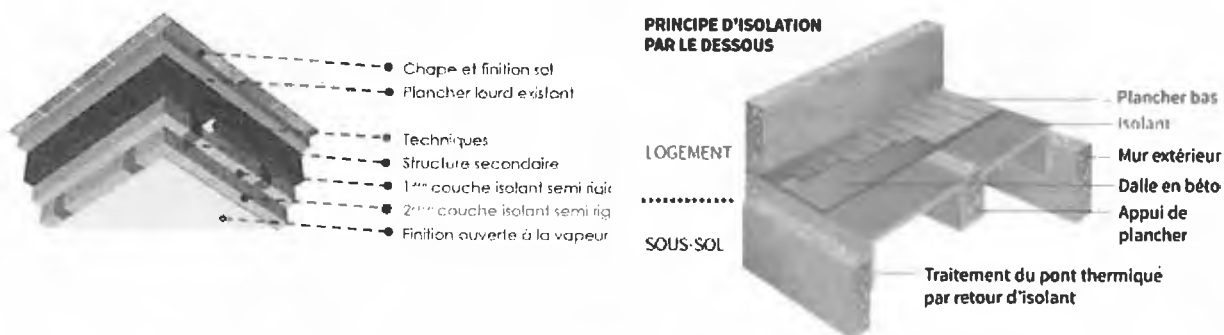
Figure 4 : Principe d'isolation (gauche) schéma du retour d'isolant (droite)
