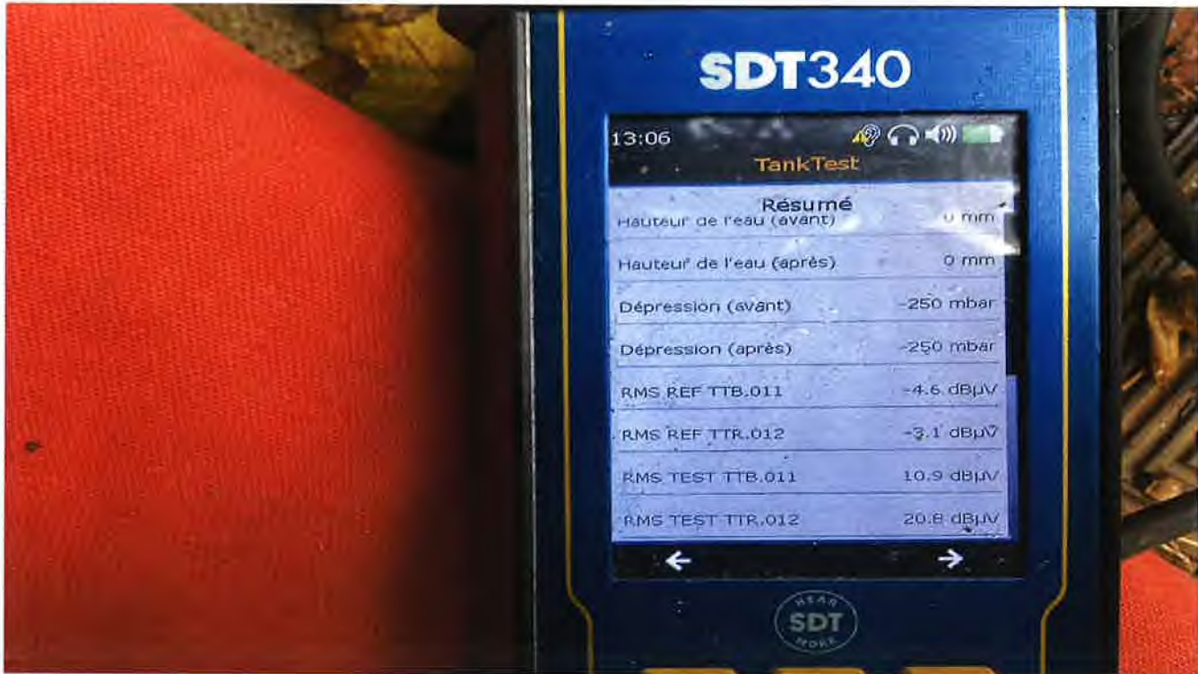
Enregistrement des capteurs avec la fuite calibrée
