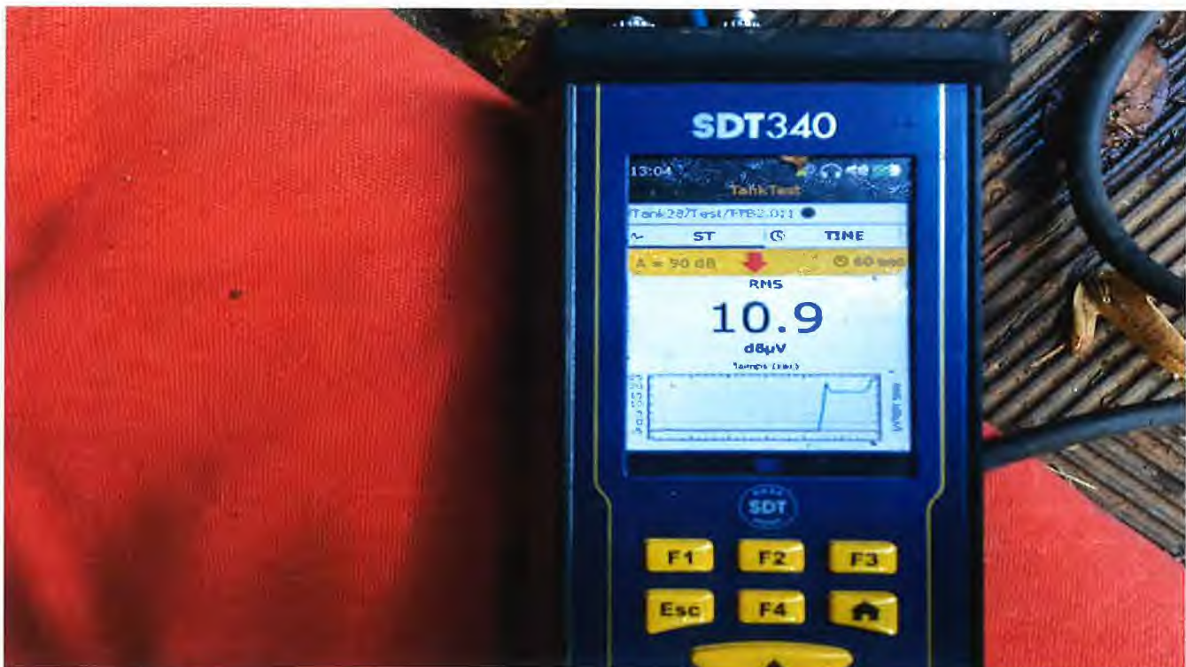
Enregistrement des capteurs avec la fuite calibrée
