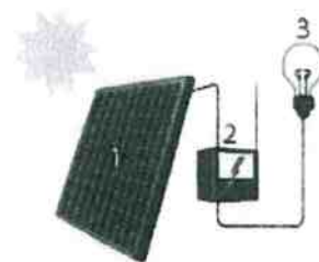
1 Zonnepaneel | 2 Omvormer | 3 Elektrische toestellen
