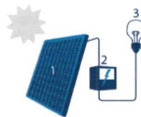
1. Zonnepaneel | 2. Omvormer | 3. Elektrische toestellen
