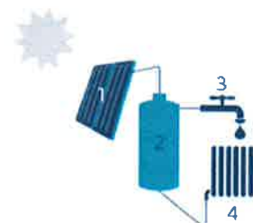
1 Zonnecollector | 2 Opslagvat zonnecollector | 3 Warmwaterkraan | 4 Radiator voor ruimteverwarming
