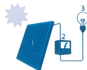
1. Zonnepaneel | 2. Omvormer | 3. Elektrische aansluitingen
