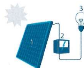
1. Zonnepaneel | 2. Omvormer | 3. Elektrische toestellen
