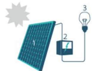
1. Zonnepaneel | 2. Omvormer | 3. Elektrische toestellen
