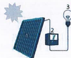
1. Zonnepaneel | 2. Omvormer | 3. Elektrische toestellen
