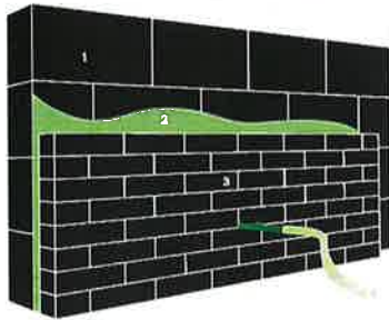
1. Dragende muur | 2. Ingeblazen isolatie | 3. Gevelsteen / gevelbekleding
