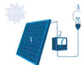
1. Zonnepaneel | 2. Omvormer | 3. Elektrische toestellen
