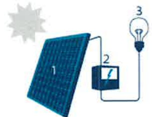
1. Zonnepaneel | 2. Omvormer | 3. Elektrische aansluiting
