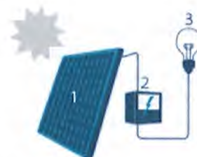
1 Zonnepaneel | 2 Omvormer 3 Elektrische aansluiting
