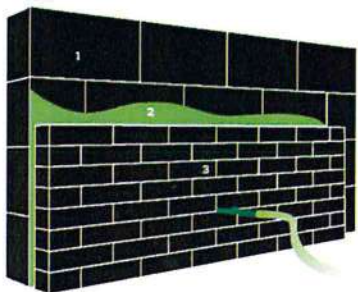
1. Dragende muur | 2. Ingeblazen isolatie | 3. Gevelsteen / gevelbekleding
