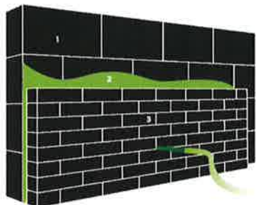
1. Dragende muur | 2. Ingeblazen isolatie | 3. Gevelsteen / gevelbekleding
